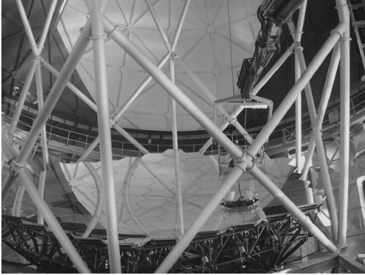
図1 南アフリカ天文台大望遠鏡 (SALT) のセグメント主鏡 ©SAAO 2005.
