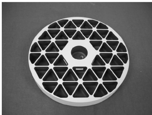
図6 試作中の 33 cm ZPF 鏡材.
