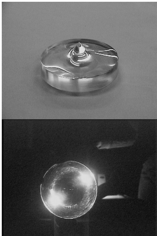
図1 重力レンズ模型 1) 。重力レンズの屈折法則に合わせて、アクリル樹脂を削りだして作成したもので、二重像やアインシュタインリングを再現できます。
