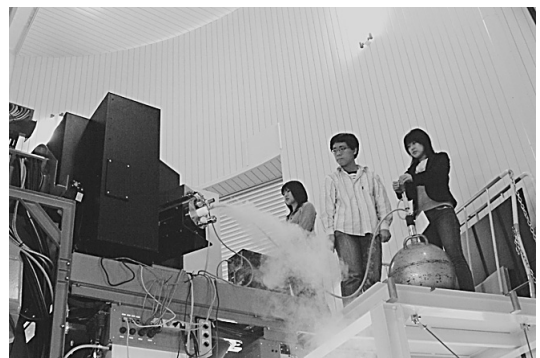
図4 西はりま天文台なゆた望遠鏡のナスミス台上のMALLS分光器. 液体窒素を注入して観測準備中の情景. 中央の人物が田中.
