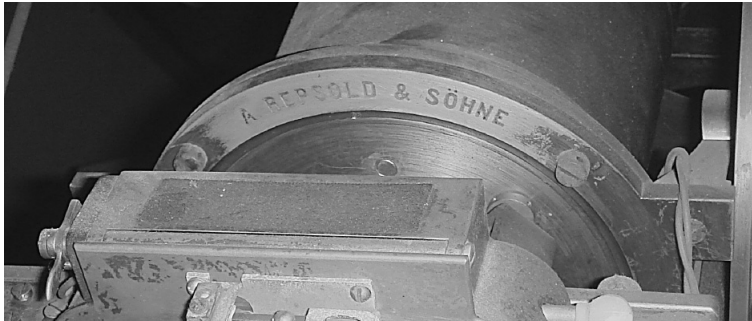
写真 13 レプソルド子午儀のマイクロメーター接眼部上部 (名盤が読める).
