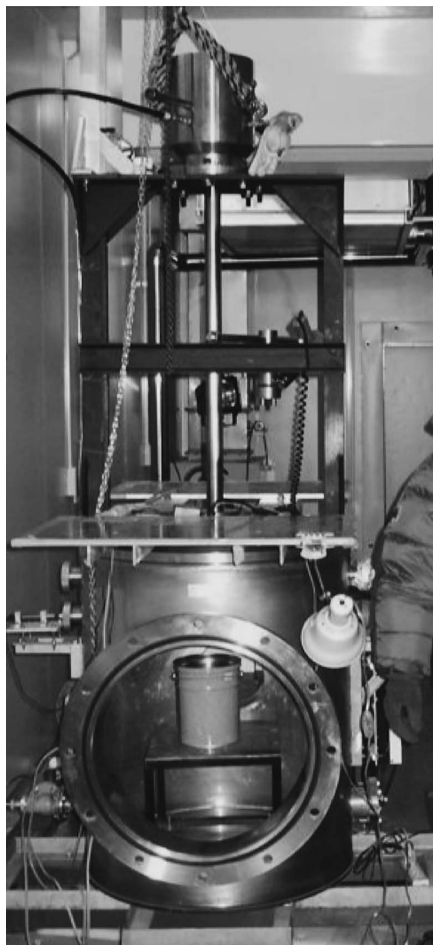
図2 縦型一段式ガス銃の写真。銃身の長さは1 mで、約700 m/sまで氷を加速できる。北大・低温研の大型低温室に設置されている。
