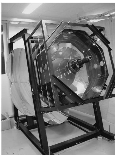
図5 Ashra 光学系の写真. 3枚の補正レンズ，球面鏡，球面焦点面からなる，修正 Baker-Nunn 光学系である．7枚の分割鏡で構成される球面鏡システム調整後のスポットサイズは，典型的に0.2 mm，約0.5分角相当である。
