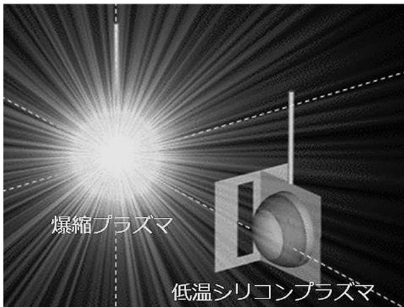
図1 X線連星のイメージ図(左)と、その実験室模擬実験のイメージ図(右)。大型レーザーで爆縮し、放射温度が0.5 keVのプランク分布を160 psの間、実験室内に生成できた。
