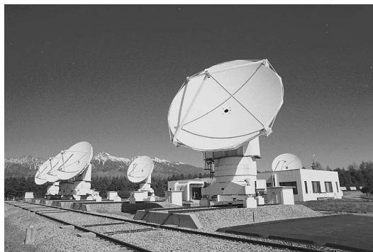
図2 左図は野辺山ミリ波干渉計の写真。野辺山ミリ波干渉計 (Nobeyama Millimeter Array; NMA) は口径 10 m の素子アンテナ 6 台から構成される電波干渉計である。6 台のアンテナは観測シーズン中に異なる三つのアンテナ配列に並び替えられる。これらの配列を組み合わせることで観測することにより、数秒角から 1 秒角の小さい天体の構造を見分けることができる電波画像を得ることができる。右図は Atacama Submillimeter Telescope Experiment (ASTE) 望遠鏡と筆者。ASTE は南米チリのアタカマ砂漠の標高 4,800 m のパンパ・ラ・ボラにある口径 10 m のサブミリ波電波望遠鏡である。
