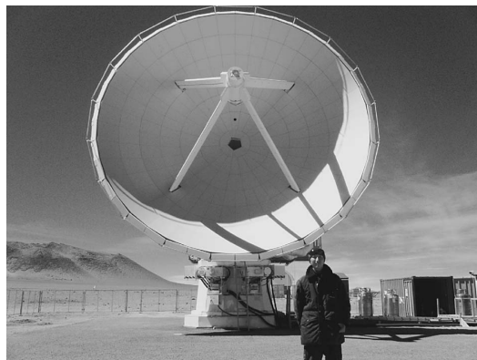
図2 左図は野辺山ミリ波干渉計の写真。野辺山ミリ波干渉計 (Nobeyama Millimeter Array; NMA) は口径 10 m の素子アンテナ 6 台から構成される電波干渉計である。6 台のアンテナは観測シーズン中に異なる三つのアンテナ配列に並び替えられる。これらの配列を組み合わせることで観測することにより、数秒角から 1 秒角の小さい天体の構造を見分けることができる電波画像を得ることができる。右図は Atacama Submillimeter Telescope Experiment (ASTE) 望遠鏡と筆者。ASTE は南米チリのアタカマ砂漠の標高 4,800 m のパンパ・ラ・ボラにある口径 10 m のサブミリ波電波望遠鏡である。
