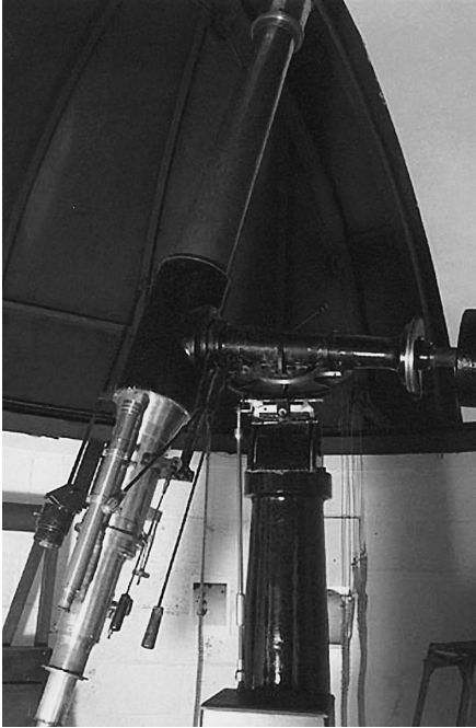
図4 ロッキヤー望遠鏡. 6.25 インチ (16 cm) 赤道儀, 7枚プリズムをもつスリット分光器を取り付け太陽高分散分光に取り組み, 1868年にヘリウムを発見した歴史的望遠鏡. 現在, シドマス・ノーマン・ロッキヤー天文台に置かれロッキヤー望遠鏡と呼ばれて公開されている.
