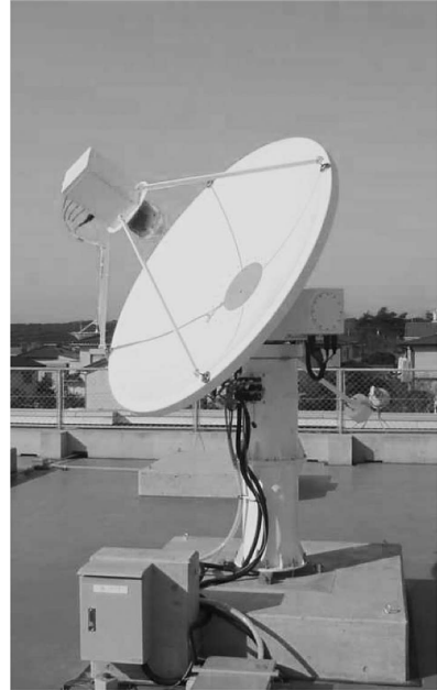
図7 情報通信研究機構 (NICT)・鹿島が開発した MARBLE 小型局アンテナ.
