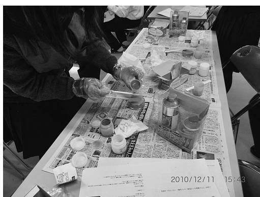
図5 シリコンの型にアクリル樹脂を流し込む作業.
