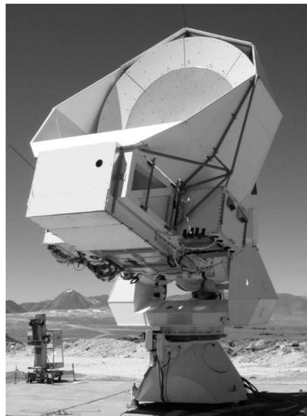
図2 POLARBEAR実験で使用しているHuan Tran望遠鏡の外観。3.5 mの主鏡（軸外しグレゴリアン光学系。水口・ドラゴン条件を満たすことで、交差偏波を低く抑えている）と250 mKまで冷やされた検出器をクライオスタット内に搭載し、CMB偏光を観測している。
