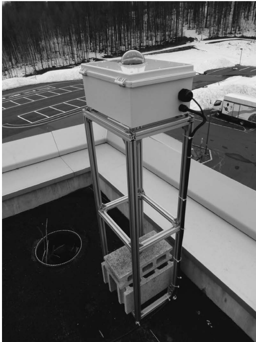
図2 北海道大学大学院理学研究院附属天文台の建物屋上に設置されたスカイモニタ (左) とハウジング内部 (右).
