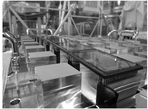
図4 木曾シュミット望遠鏡の焦点面形状（半径3,300 mmの球面）に沿って設置されたCMOSセンサ。背面のアルミ柱と両面テープにて固定されている。
