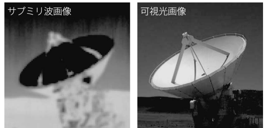
図1 サブミリ波大気透過率イメージャー (MiSTI) によって得られた ASTE 望遠鏡の電波画像 (左)。色が明るいほど放射強度が強いことを示す。サブミリ波では物体の熱放射をとらえることができる。右は光学写真。
