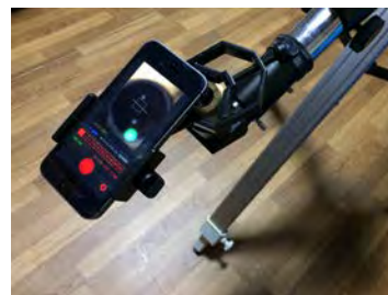
図1 スマートフォンとカメラアダプターを望遠鏡に取り付けた様子
