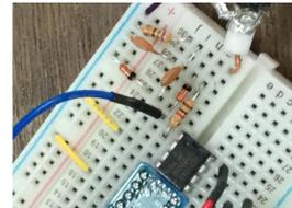
検波回路のダイオード、コンデンサー、抵抗などのパーツを、ブレッドボード上に配置して、検波器を組み立てる。
