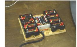
衛星電波受信機、およびブースターの電源としてテレビ受像機をしようすると、大きなノイズが現れるので、受像機電源を止めて、電池による電源供給とする。電源電圧は15V。
