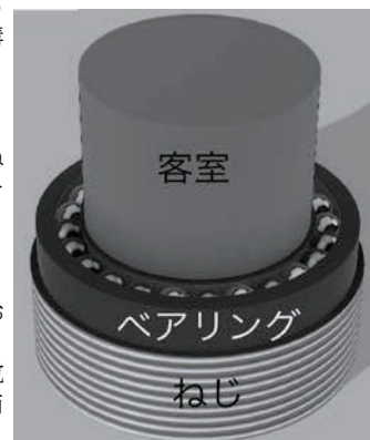
図1. リニアモーターを用いたねじ式宇宙エレベーターの構造のイメージ
