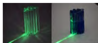
図5 プラスチック棒に細いLED光(緑色)を当てる 左：透明 右：青く塗ったもの
