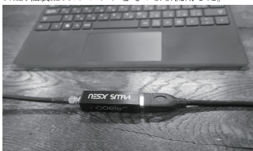
図1 アンテナ線に接続したSDR無線機
