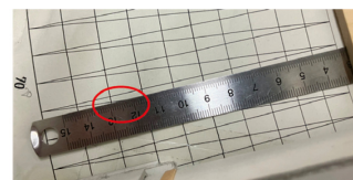
図2 1度毎に引かれた主尺の間の副尺(斜線)と定規の交点を読む(図の場合は21.25度)。
