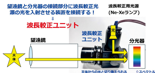
図1 波長校正ユニットの仕組み
