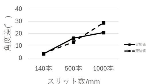
図1 回折格子のスリット数と角度差の関係
