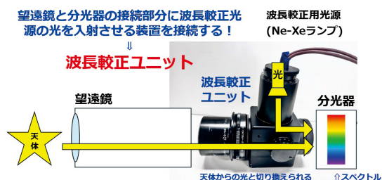
図1 波長校正ユニットの仕組み
