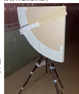
図3 製作した四分儀
