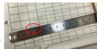
図2 1度毎に引かれた主尺の間の副尺(斜線)と定規の交点を読む(図の場合は21.25度)。
